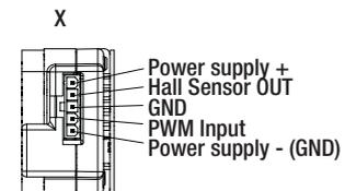
passend für Steckergehäuse Mini-Fit, Jr. (Fa. Molex)
