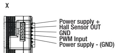
passend für Steckergehäuse Mini-Fit, Jr. (Fa. Molex)
