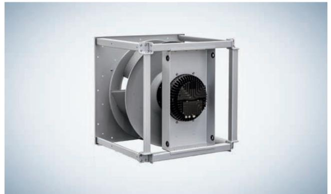
**FanGrid-Module** sind RadiPac Radialventilatoren mit Tragspinne in einer speziellen Würfelkonstruktion. Die vormontierten Einheiten in den Baugrößen 400 bis 560 wurden für den Aufbau der sogenannten FanGrid konzipiert. Sie eignen sich für Anwendungen mit sehr hohen Luftmengen, die von einem einzelnen Ventilator in der nötigen Kompaktheit nicht erreicht werden können.
