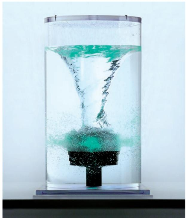
Motoren werden zwar nicht unter Wasser betrieben, aber wir wollten es genau wissen: 1.700 Stunden Dauerbetrieb ohne Probleme. Test bestanden!
