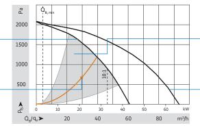
Der Betriebspunkt des Systems (Venturi und Gasgebläse) bewegt sich entlang der typischerweise quadratischen Systemkennlinie. Unter der Annahme einer bekannten Gasart, z. B. G20, wird die minimale Heizleistung  $\dot{\Omega}_{B,min}$  für ein System nur durch den Venturi-Düsendurchmesser bestimmt. Bei einem Mindestventuridruck von 40 Pa für ein typisches mechanisch-pneumatisches Gasventil wird  $\dot{\Omega}_{B,min}$  auf Seite 21 angegeben.
